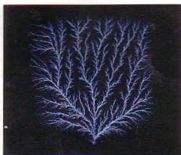
24.15 Un campo eléctrico muy intenso provocó la ruptura del dieléctrico en un bloque de Plexiglas. El flujo de carga resultante grabó este dibujo en el bloque.
