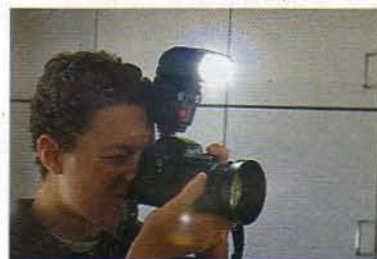
24.9 Una unidad de destello electrónico almacena energía potencial en un capacitor. Al oprimir el botón del obturador de la cámara se crea un camino conductor de una placa del capacitor a la otra a través de la lámpara de destellos. Una vez que se establece este camino y el capacitor se descarga, la energía almacenada se convierte en un destello luminoso breve aunque intenso.
